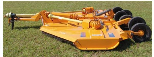
**CABECERA** con estabilizador unido al sistema de rodaje. Efectua el nivelamiento automático de la cortadora
