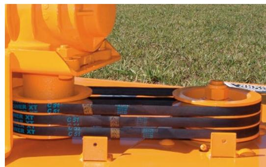
Correas en "V", con tensor de fácil ajuste.
